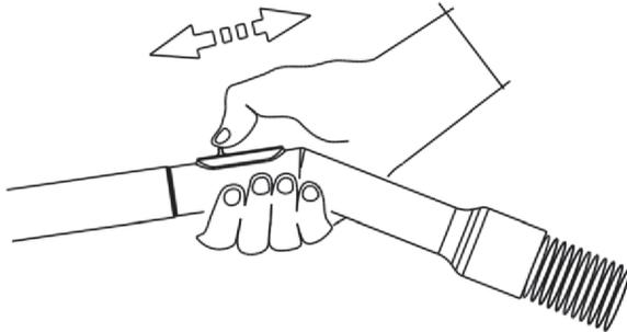
Das Metallrohr mit dem Handgriff des Saugschlauches zusammenstecken und das Zubehörteil dem Rohr anschließen.
